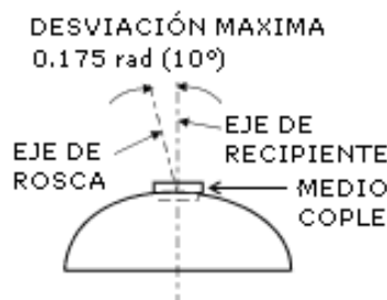
DESVIACIÓN DEL EJE DE LA ROSCA CON EL EJE DEL RECIPIENTE
