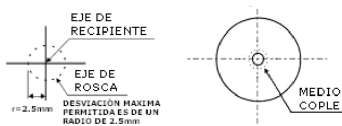
CONCENTRICIDAD DEL EJE DE LA ROSCA
